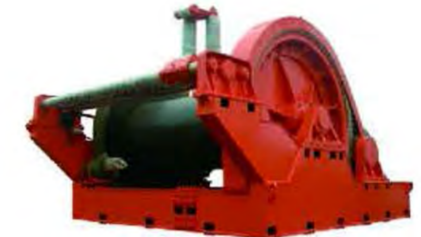
烟台莱福士2万吨门式起重机主起升用 JM65吨卷扬机 容绳量：3600m 额定速度：10.5m/min
