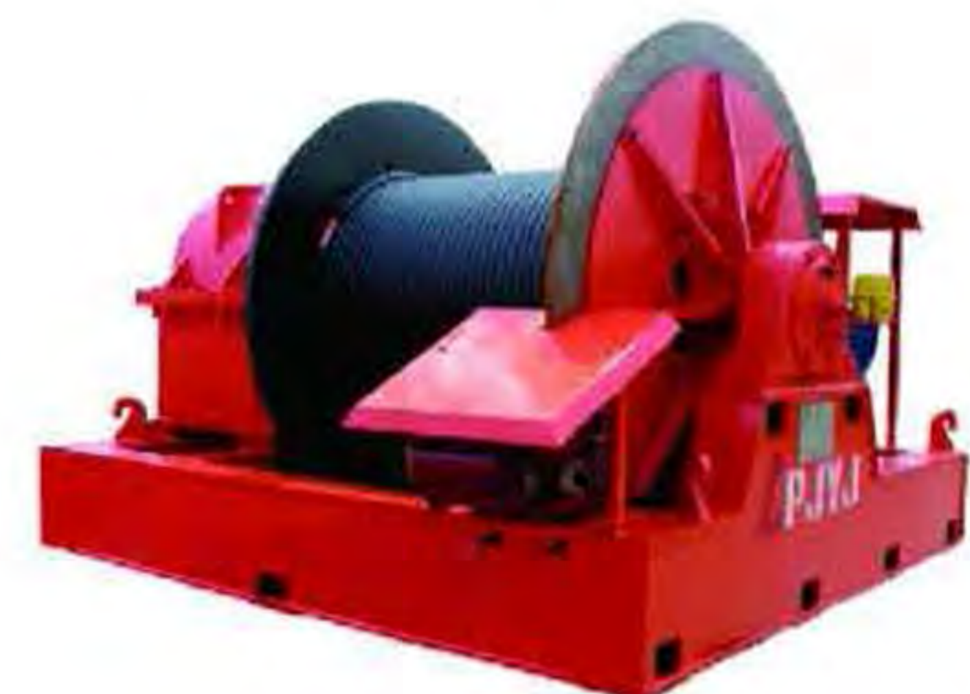
中铁十四局900吨架桥机主起升用 JT12吨卷扬机 容绳量：410m 额定速度：14m/min
