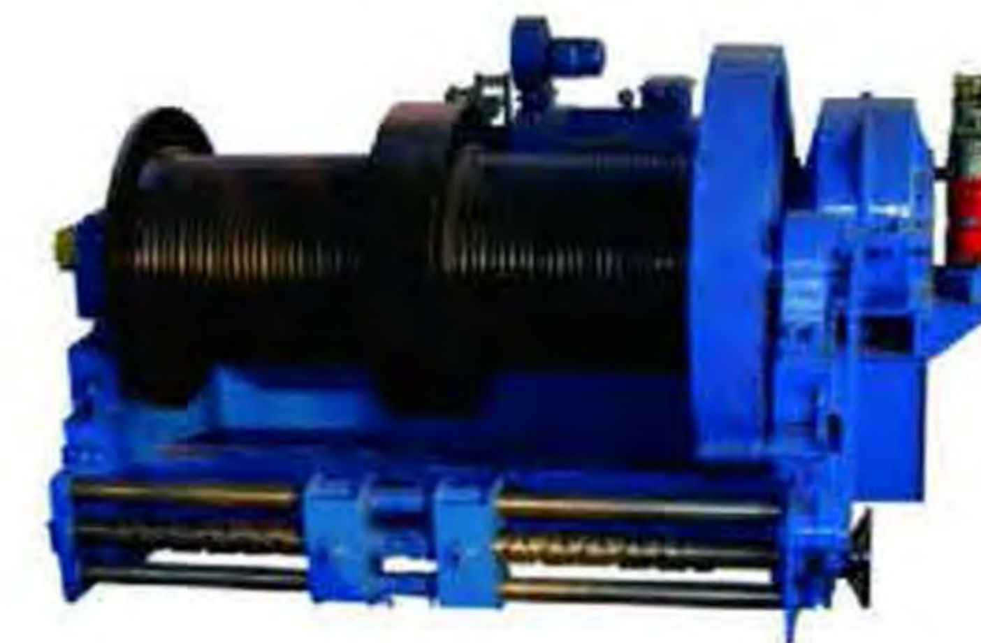
河南矿山75T-75m起重小车主起升用 JM2x10吨卷扬机 容绳量：2x350m 额定速度：10m/min
