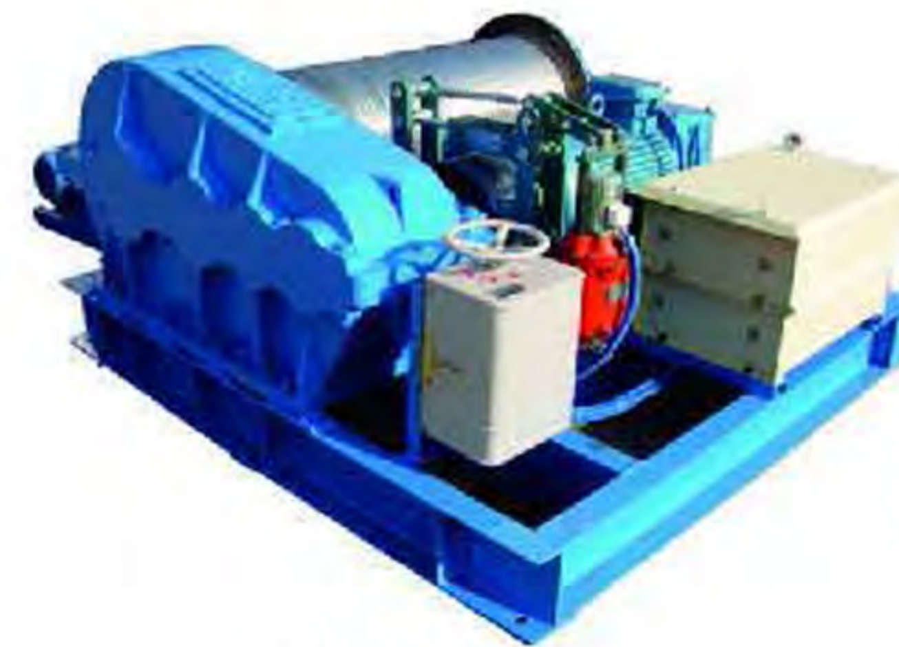
JM8吨慢速卷扬机 绳速：9m/min 行程：40m 首钢集团迁安钢厂拉钢包用
