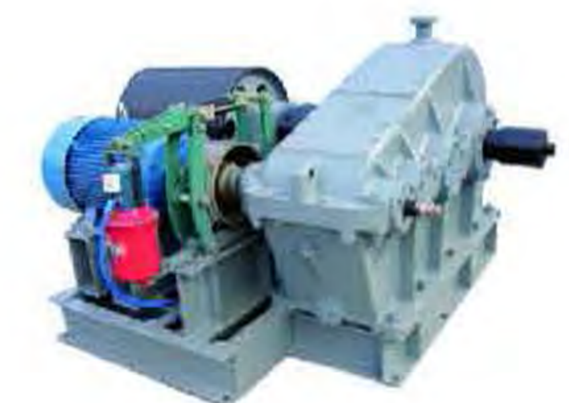
JK5吨快速卷扬机 绳速：49.2m/min 行程：40m 洛阳矿业集团纳米公司石灰窑上料用
