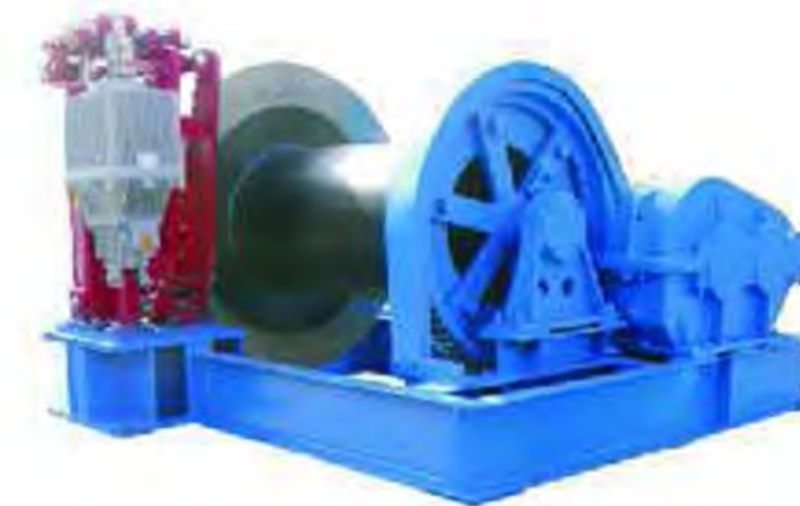
JM10吨慢速卷扬机拉力100KN 绳速：9.5m/min 容绳量：300米 中铁大桥局80吨门式起重机用
