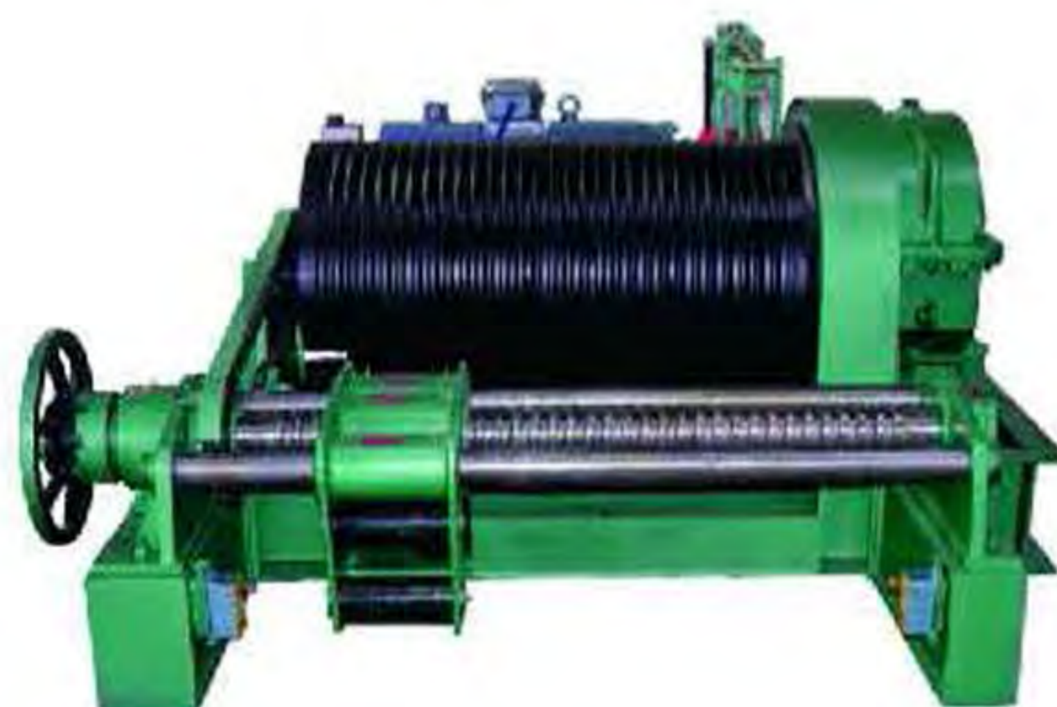
JM10吨变频调速卷扬机 (带排绳器) 钢卷轧机生产线拉钢带用
