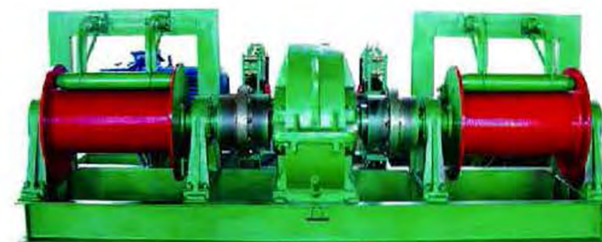
为洛阳热电厂烟囱检修工程配套2JK5卷扬机, ( F=50\text{KN} , V=20\text{m/min} , d=21.5\text{mm} , L=2 \times 220\text{m} ) 其结构特点: 双绳起吊, 安全; 配压绳器, 钢丝绳排列整齐。
